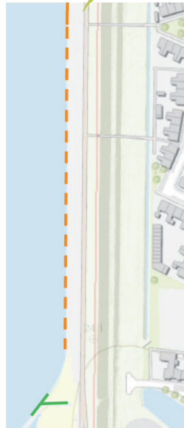
Op de afbeelding is op de oranje stippellijn de zandstrook aangegeven. In de aan te brengen stortsteen komen er 5 à 6 openingen. Met de groene lijn is het niet officiële strandje aangegeven. Ook hier komt een opening.
